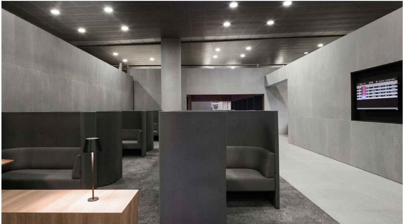
Abb.: Geschützte Sitzbereiche schirmen die Fluggäste innerhalb des offenen Raumgefüges etwas ab und tragen zum Schallschutz bei. Die Beleuchtung setzt sich hier aus den Downlights und indirekten Lichtquellen zusammen.
